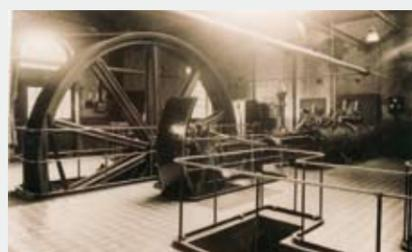
Dampfmaschine mit Schwungrad der Firma Colson Kupferdreh
